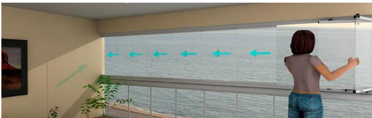
3º Passo – Para fechar completamente o último painel, destrave o pino superior, puxando a corda para baixo e, mantendo-a tensionada, empurre o painel de volta ao trilho. Feito isso, solte a corda para travar o pino.
