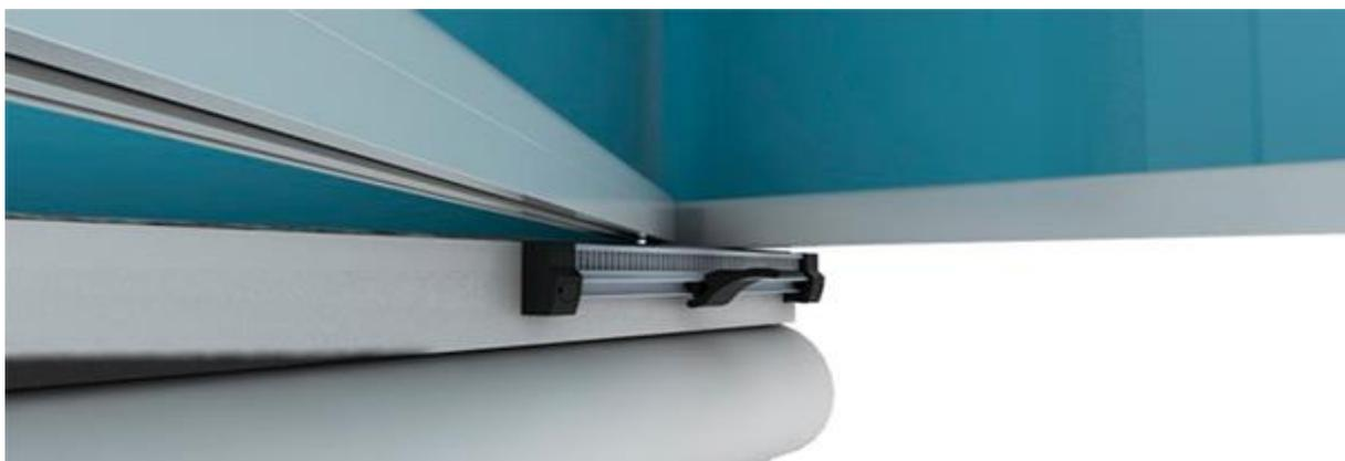
2º Passo – Gire o painel encaixando-o de volta aos trilhos superior e inferior, e, segurando-os pelo centro, deslize-os até o final. Repita esse processo com os demais painéis;
